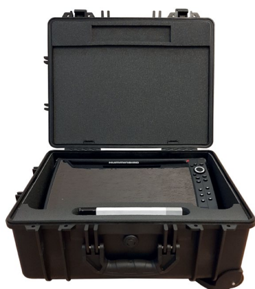
Блок управления с монитором и гидролокатором бокового обзора
