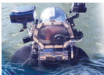
Крепление звуковизора МПК «ОБЗОР» на водолазный шлем
